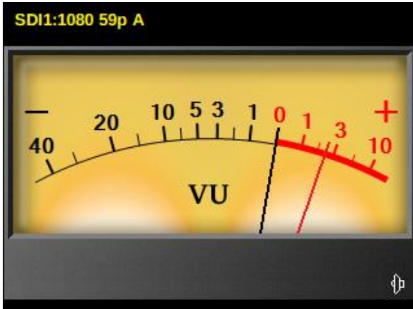
SDI1入力(1080 59pA)、ピークホールド1.5s、1/2chモニタリング,針式VUメーター(Normal)表示
